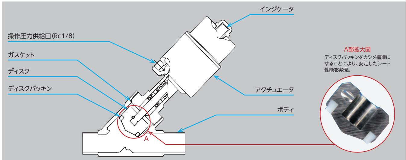
アクチュエータは360°回転可能、操作圧力供給口の向きを調整出来ます。
