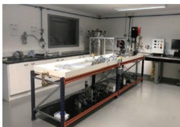
CARTEN®のオンサイト研究開発技術センターはそれぞれの業界に基づいたテスト条件を再現します。動的流動と高静圧条件が複製され、すべての業界オプションとの互換性を確認するため、複数のチューブ化合物およびブランドが検証されます。これにより、製薬会社は、CARTEN®のオープンアーキテクチャ装置をリスクなしで利用し、安心して必要なオプションの選択を行えます。お客様特定のテスト分析は、必要に応じてオンサイトで再現できます。
