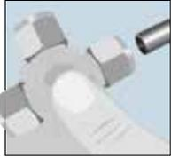
チューブをニューV-Lokに差し込みます。チューブ端が継手ボディショルダー部に突当たるまで差込まれているか確認し、ナットが指で回らなくなるまで締付けた後ボディとナットに合マークを付けて下さい。これを締付け時のゼロポイントとします。
