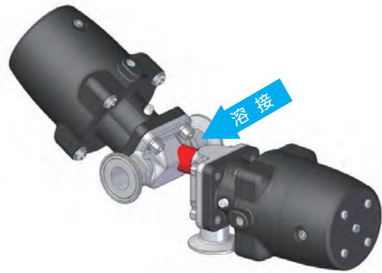
このデッドレグを小さくするため、T継手を排除し、バルブボディに直接もうひとつのバルブを溶接し、デッドレグを小さくします。
