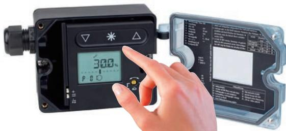
【操作1】 4mAの信号入力、及び供給圧力の導入
