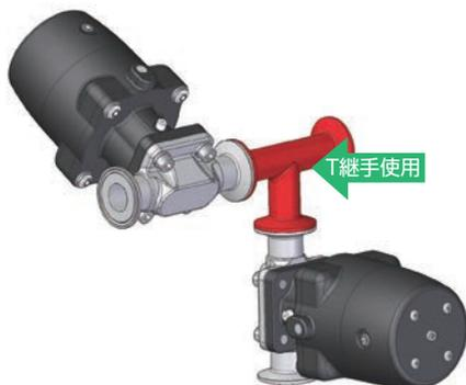
水平のバルブと垂直のバルブを配置するような分岐配管の場合、図のようにT継手を用います。しかし、この場合大きなデッドレグが発生します。
