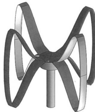
先細バタフライ風車 【略称：先細バタ】
